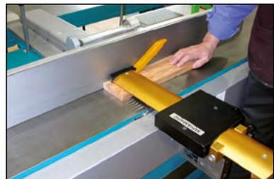
**Bild 5: Betriebliche Sicherheitseinrichtung, Messerwellenabdeckung bei einer Abricht- und Hobelmaschine**
