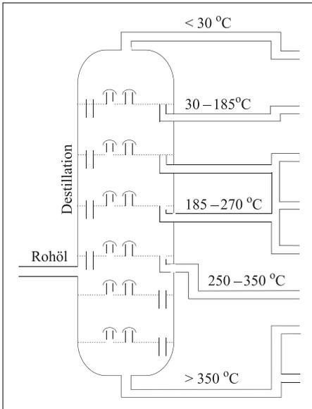
Abb. 6: Fraktionsturm zur Erdöldestillation
