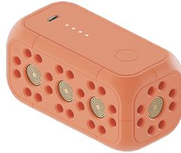
Der **Hauptblock** ist das wichtigste Teil von Robo Wunderkind. Dieser Block ist das »Herzstück« und die Verbindung zu den einzelnen Blöcken und zur App. Deshalb muss dieser Block auch zwischendurch mit dem beiliegenden Kabel per USB und Strom geladen werden, damit er Energie hat und auch die angebauten Blöcke mit Strom versorgen kann. Ohne diese Stromversorgung kann die App die Verbindungsblöcke nicht erkennen und so können sie dann auch nicht programmiert werden.
