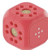
Der Beschleunigungssensor ist ein cooles Teil. Er hilft dir dabei, die Beschleunigung und/oder Position deines Roboters im 3D-Raum zu messen, und erkennt dann zum Beispiel, ob er bewegt wird, und reagiert darauf.
