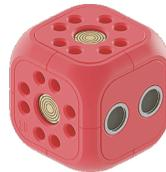
Der **Entfernungssensor** erkennt Gegenstände und misst Abstände zu Wänden oder Objekten, die sich vor dem Roboter befinden.
